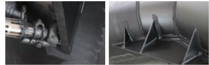
SPOSTAMENTO IN HDPE Ø1200 CON SCARICO CONDENZA CERN - GINEVRA
